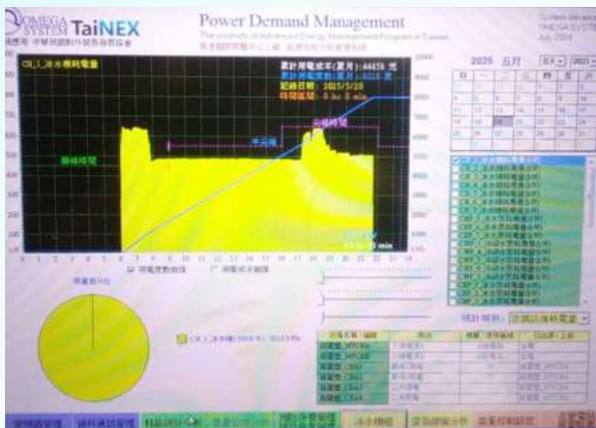
水泵一次側加裝 3 台變頻器，並導入 AI 控制轉速機制，依負載自動調節運轉
